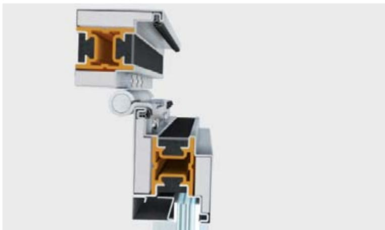
**AF EI 30** è un sistema integrato di accessori, guarnizioni e profilati a taglio termico con profondità di 65 mm che permette di realizzare un'ampia gamma di porte e di partizioni vetrate resistenti al fuoco.
