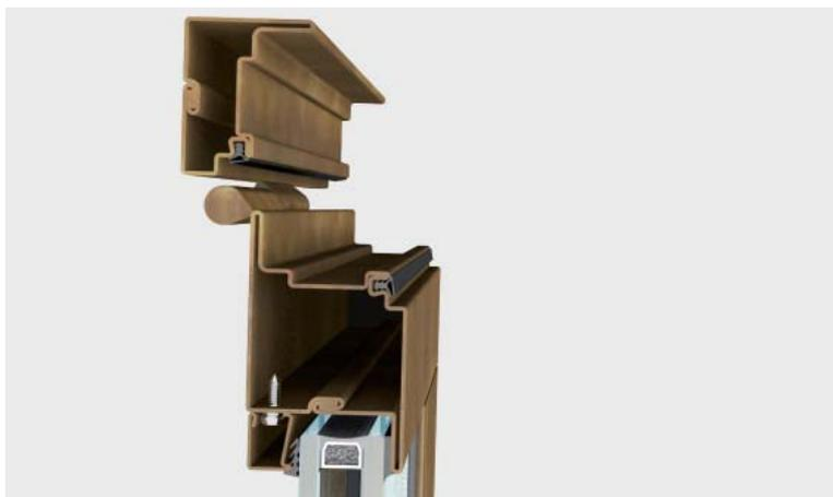
**sistemacciaio porta** è un sistema integrato di accessori, guarnizioni e profilati non isolati termicamente aventi profondità di 55 mm che consente di realizzare un'ampia gamma di porte, rettangolari, sagomate o curve. Si possono installare vetri a doppia camera fino a 35 mm di spessore. Le caratteristiche di tenuta dei serramenti sono garantite da un sistema a doppia guarnizione di battuta su tre lati e da una guarnizione a ghigliottina automatica sottozoccolo.
