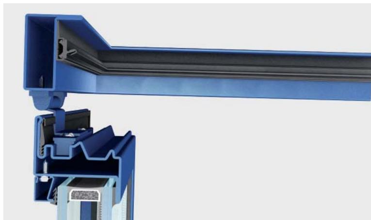
**security** finestra è un sistema integrato di accessori, guarnizioni e profilati non isolati termicamente aventi profondità di 60 o 68,5 mm che consente di realizzare un'ampia gamma di finestre, rettangolari, sagomate o curve e di installare vetri isolanti fino a 48 mm di spessore.
