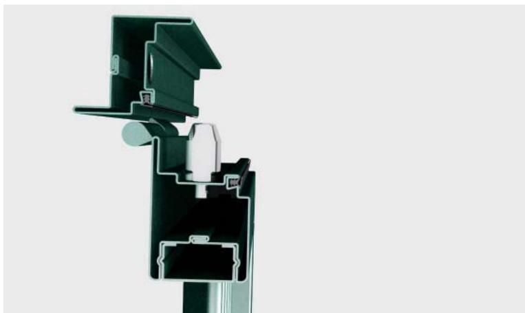
**blindacciaio** è un sistema di profili, accessori e guarnizioni con sezione di 55 mm e spessore 15/10, per la realizzazione di persiane e grate blindate. L'elevato standard di sicurezza degli elementi finiti viene raggiunto grazie allo spessore di 15/10 dei profilati, alla saldatura angolare dei telai e delle ovaline all'interno dei profili e alla particolare conformazione della sezione interna, che permette di utilizzare ferramenta e accessoristica di alta qualità.
