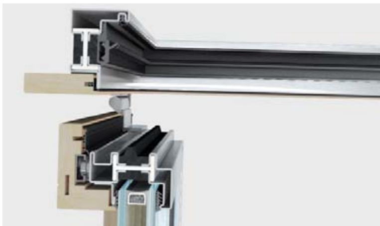
ML è un sistema integrato di accessori, guarnizioni e profilati a taglio termico con profondità di 91 mm che consente di realizzare un'ampia gamma di finestre, rettangolari, sagomate o curve e di installare vetri isolanti fino 50 mm di spessore. Le caratteristiche di tenuta dei serramenti sono garantite da un sistema a giunto aperto con tre livelli di tenuta. È possibile sostituire il rivestimento interno in legno senza rimuovere il serramento.
