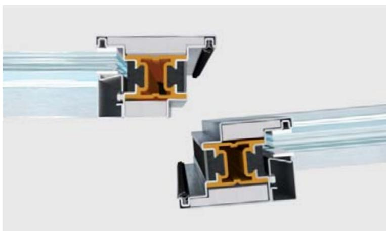
La capacità del serramento di non far passare le fiamme e i fumi caldi (tenuta al fuoco E) è garantita dalla strutturabilità del profilo e dal sistema a doppia guarnizione di battuta. La capacità di contenere la temperatura dal lato non esposto alle fiamme (isolamento I) è ottenuta grazie allo speciale taglio termico costituito da speciali resine antifluo.
