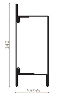
i profili **sistemacciaio** P.2--- sono forniti in acciaio inox e ottone con spessore 12/10
