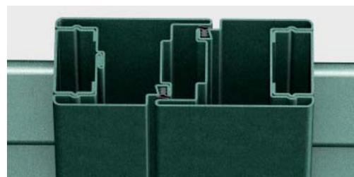
nodo centrale | sezione in vista 131 mm
