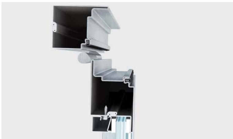
**AF Ew 30/60/90** è un sistema integrato di accessori, guarnizioni e profilati non isolati termicamente con profondità di 55 mm e consente di produrre un'ampia gamma di porte e di partizioni vetrate resistenti al fuoco. Si possono installare vetri singoli o vetri camera con spessore fino a 35 mm. Ogni tipologia è provvista di apposita accessoristica certificata integrata al sistema.
