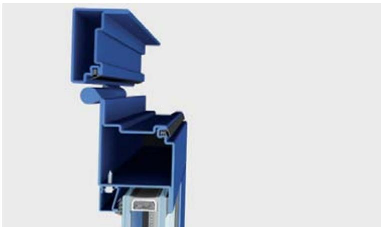
**security porta** è un sistema integrato di accessori, guarnizioni e profilati non isolati termicamente aventi profondità di 60 mm che consente di realizzare un'ampia gamma di porte, rettangolari, sagomate o curve. Si possono installare vetri a doppia camera fino a 40 mm di spessore. Le caratteristiche di tenuta dei serramenti sono garantite da un sistema a doppia guarnizione di battuta su tre lati e da una guarnizione a ghigliottina automatica sottozoccolo.
