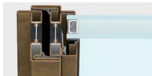
nodo laterale | sezione in vista 62 mm
