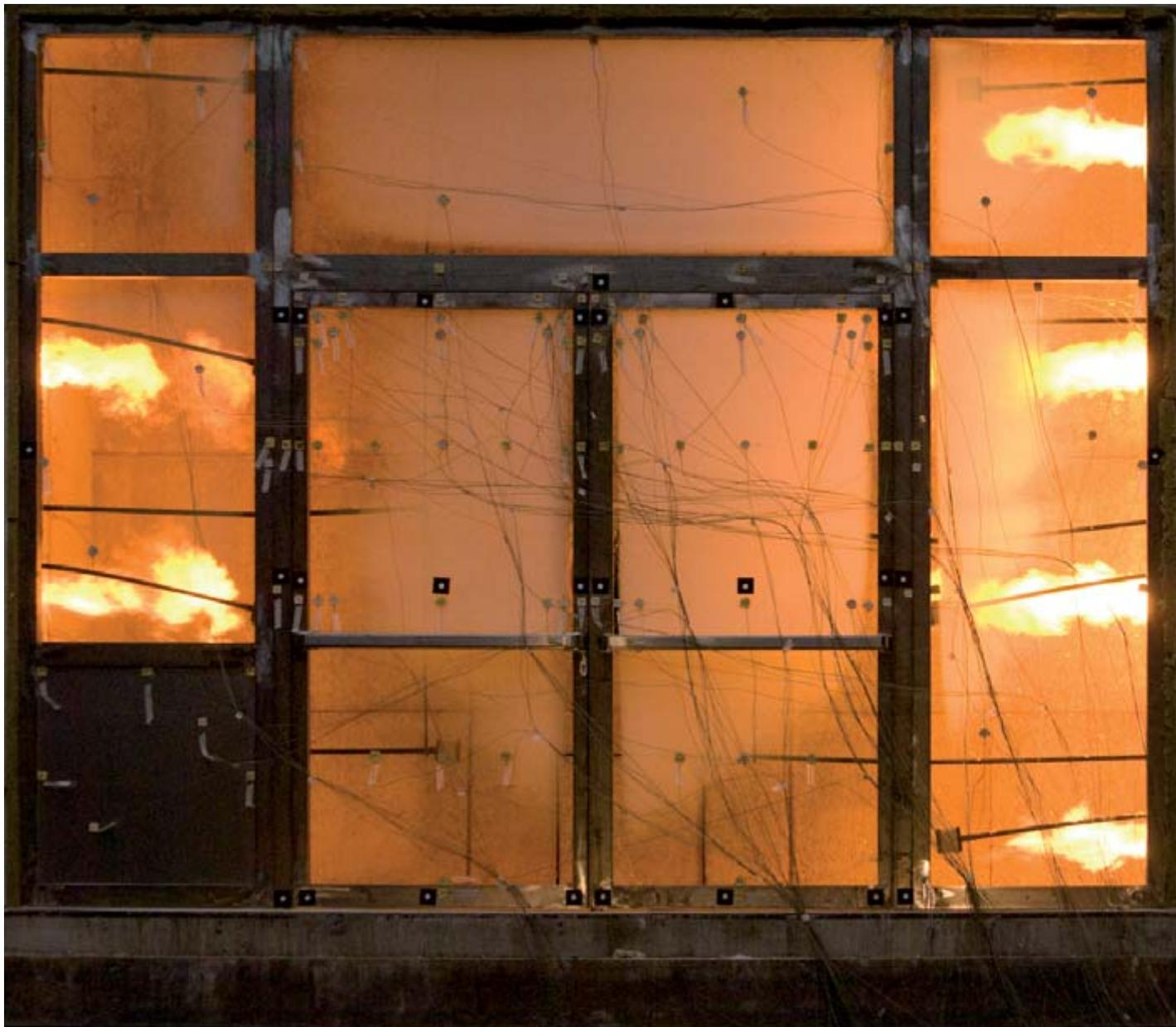
La capacità di un infisso di resistere alle grandissime sollecitazioni causate da un incendio viene testata in appositi laboratori provvisti di speciali forni e strumentazioni secondo delle procedure strettamente normate dalla comunità europea. Il test si esegue su un campione costruito in scala reale nel quale tutti i componenti - profili, vetri,
