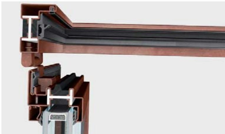
EBE 65 finestra è un sistema integrato di accessori, guarnizioni e profilati a taglio termico aventi profondità di 65 o 73,5 mm che consente di realizzare un'ampia gamma di finestre, rettangolari, sagomate o curve e di installare vetri isolanti fino a 48 mm di spessore. Ogni tipologia è provvista di apposita accessoristica (anche a scomparsa) integrata al sistema.
